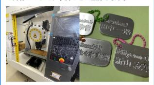
電子機械科では、マシニングセンタ(MC)と呼ばれる自動工作機械を使用して「オリジナルネームプレート」を製作します。デザインは3D-CADで行います。自分の考えたデザインが、MCで削り出される工程を間近で見ることができます。プレートの材質は、軽くて光沢も持続する金属、アルミニウムです。
